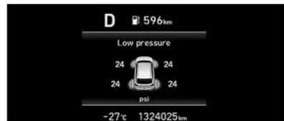
Système de surveillance de la pression des pneus (TPMS)
